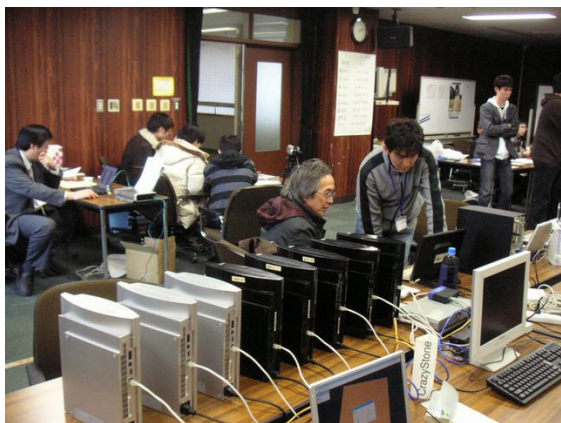
図1 今回使ったハードウェア．デスクトップ PC 1台と PLAYSTATION3 8台の混合型 PC クラスタ．山下宏氏撮影．
