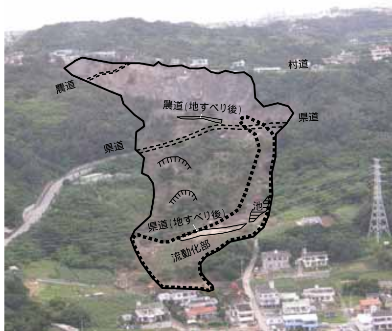
写真 - 10 地すべり右翼部二次すべりと末端流動化部の拡大（沖縄総合事務局 Website より得た写真に加筆，6月16日撮影）
